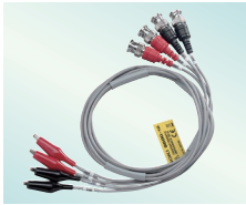
9500-10 4端子探头 可使用频率: DC ~ 200kHz 可测量端子直径: 0.3 ~ 2mm 线长: 1m
