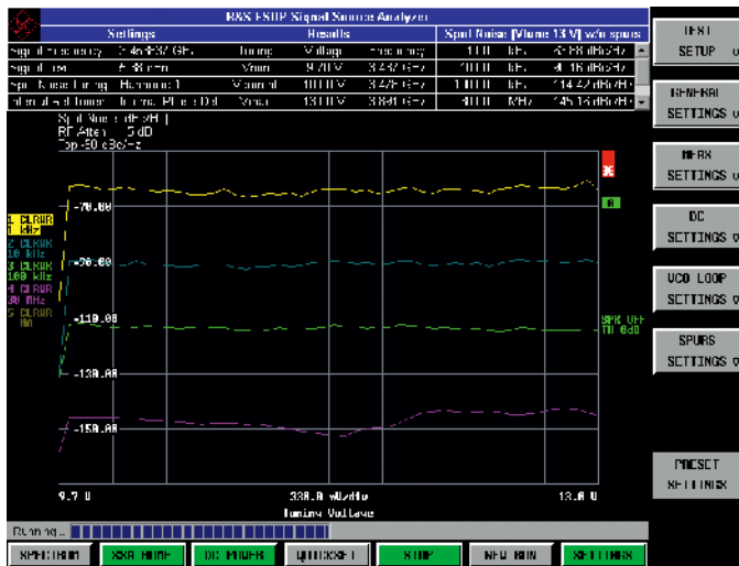
振荡器在不同偏置频率下的相位噪声值与调谐电压间的关系
