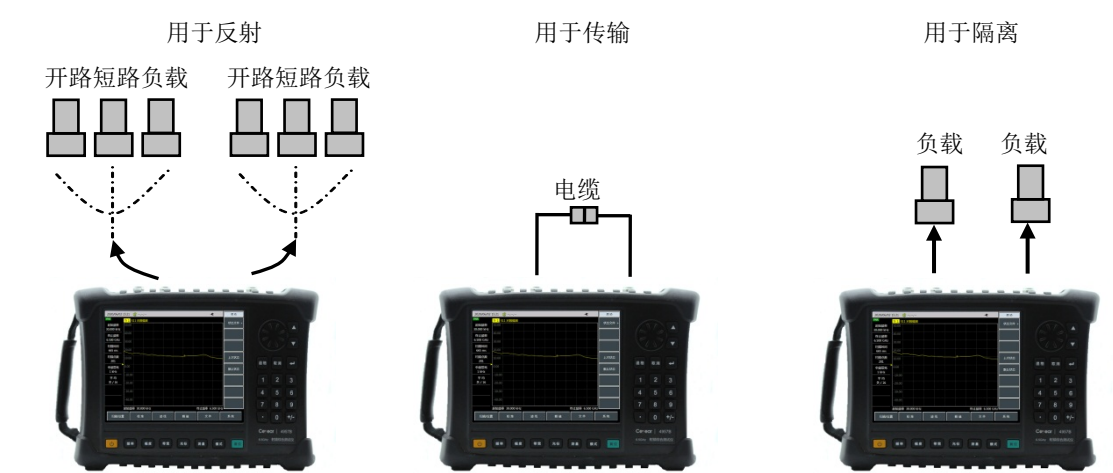
图 3.5 全二端口误差修正的标准件连接
