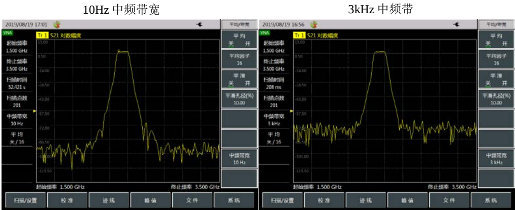
图 3.6 中频带宽对测量结果的影响
