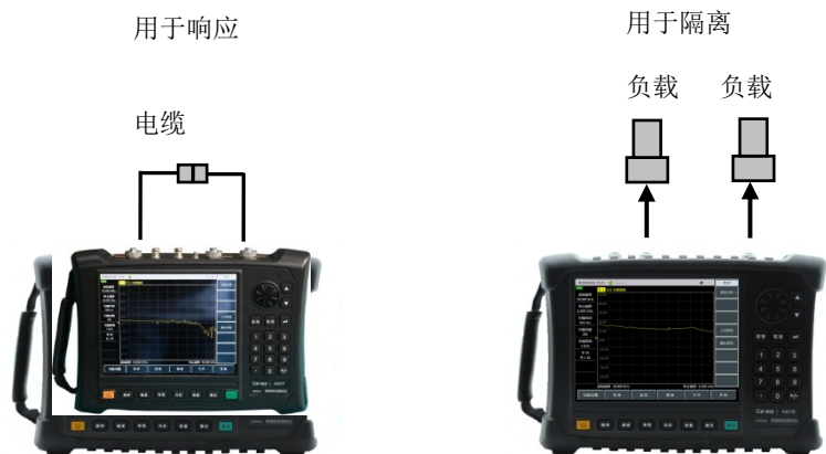
图 3.3 传输测量响应与隔离误差修正的标准件连接
