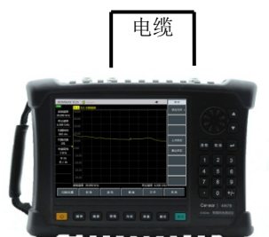
图 3.2 传输测量响应误差修正的标准件连接
