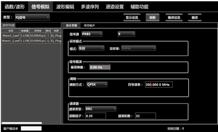
图 3.34 IQ 信号模拟插件生成 500MHz QPSK 调制信号（实时）
