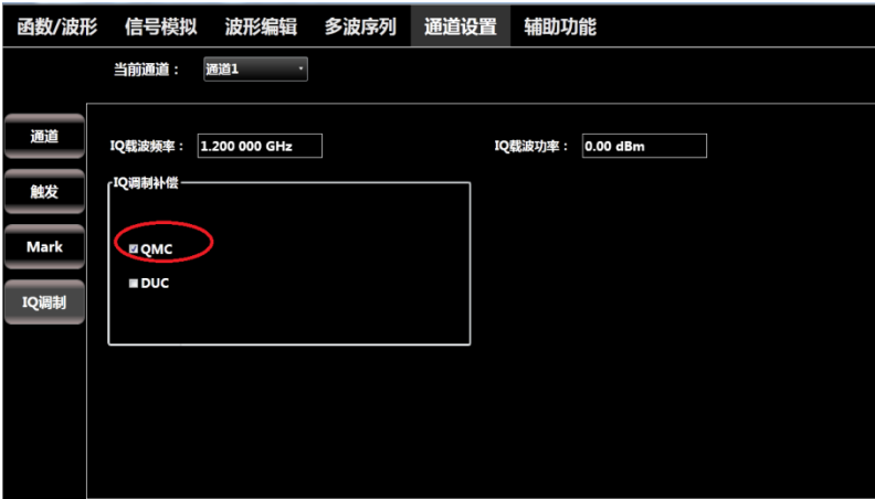
图 3.35 开启通道 1&2 的 IQ 宽带补偿功能
