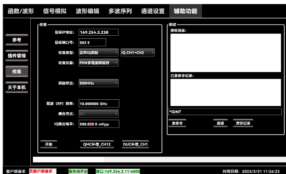
图 3.32 1652B 宽带校准界面
