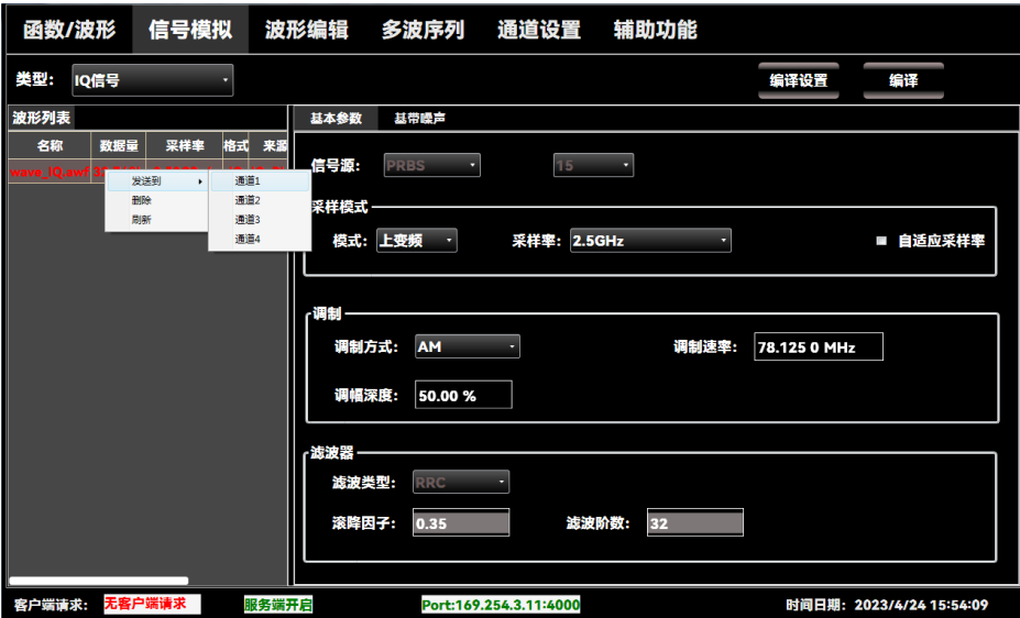
图 3.18 将 AM 上变频模式信号发送到通道 1
