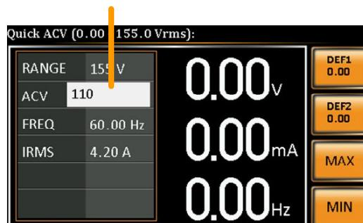
使用方向键和可调旋钮编辑参数值
