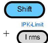
2. 使用可调旋钮/键盘或 F3 ~ F4 软键设置峰值电流。MAX 和 MIN 软键设置最大和最小峰值电流
