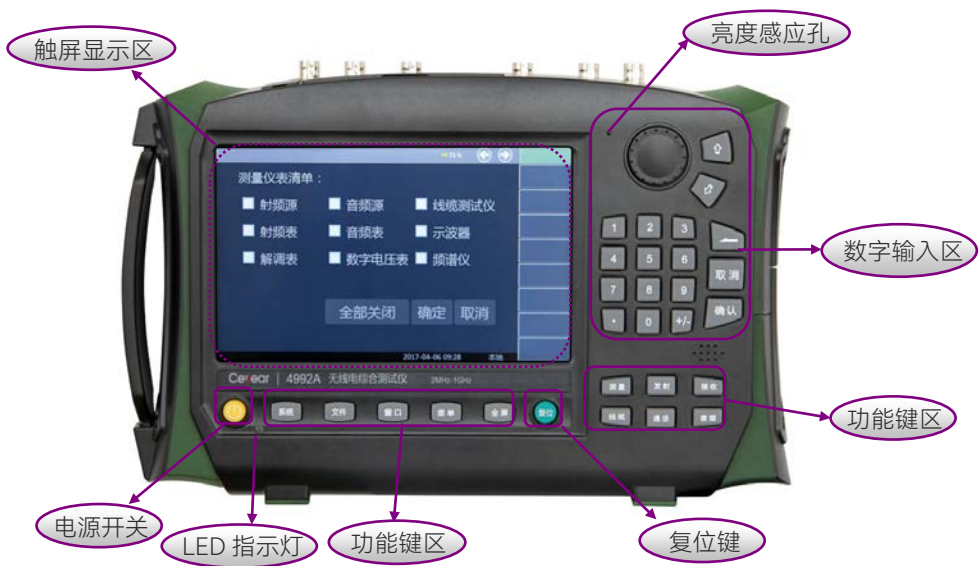
图 2.5 4992A 手持式无线电综合测试仪前面板
