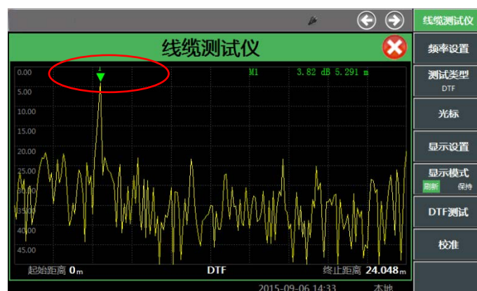
3.21 DTF 回波损耗测试曲线图
