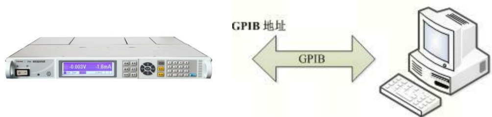
图 5.5 GPIB 接口连接图
