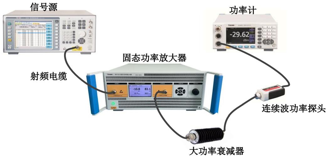
图 14 功率放大器测试示意图
