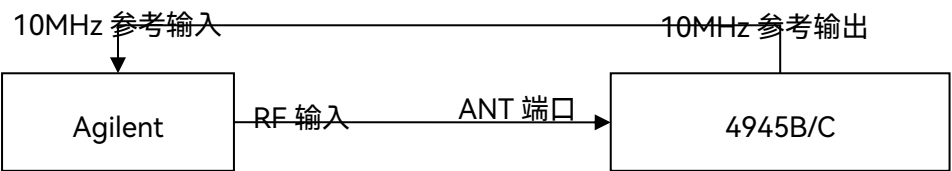
图 7.11 扫频频谱分析特性测试框图
