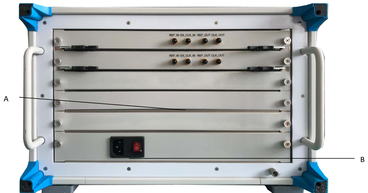
图 3.11 1612A 型无线信道仿真器后面板示意图
