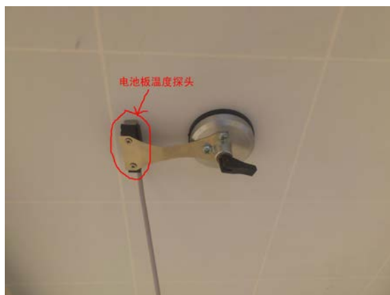
图 4-3 方形温度探头安装示意图
