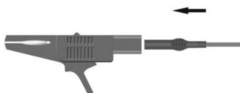
图 4-5 测试线与鳄鱼夹连接示意图
