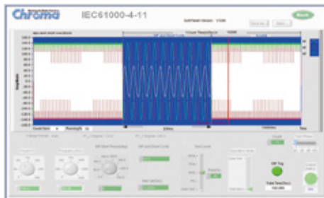
电压瞬断法规测试
