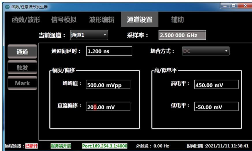
图 3.11 幅度、偏置和通道间延时设置界面
