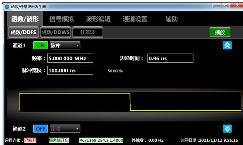
图 3.5 脉冲输出设置界面
