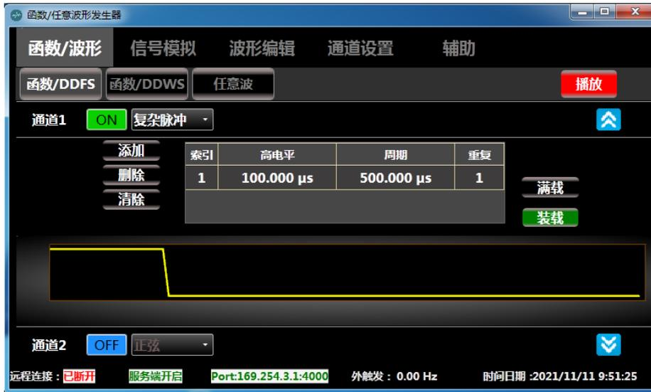
图 3.6 复杂脉冲添加第 1 条子脉冲
