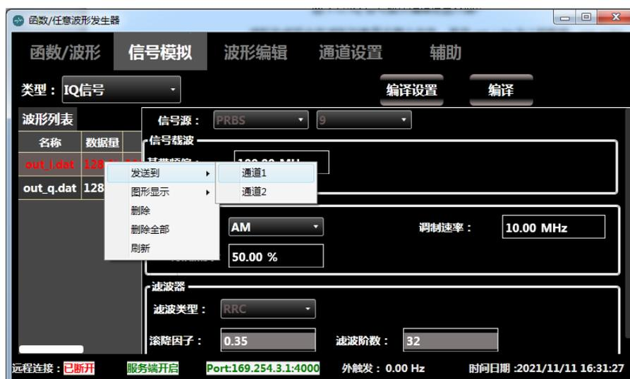
图 3.15 将 AM 信号 I 路数据发送到通道 1
