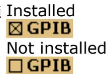
**檢查 GPIB 自我測試結果** 1. 按 System 鍵，檢查內部 GPIB 功能測試結果。
